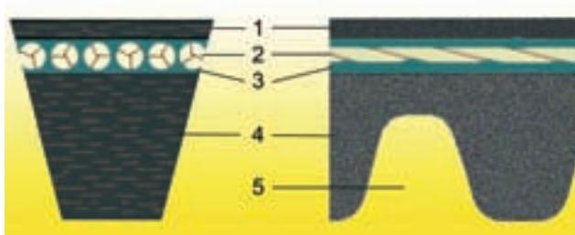
1. Die Gewebelagen des Oberbaus stützen den Zugstrang ab, der Strongbelt maximum erhält dadurch seine hohe Flexibilität.
