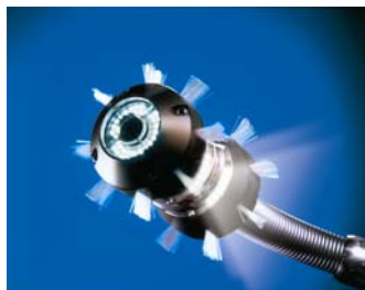
P455 Kamera mit zwei Kamera-Modulen, für Vor- und Seitenblick
