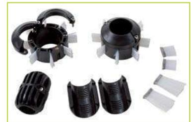
Jedes P340 flexiprobe System ist mit einem einfach zu montierenden Universalbürstengestellsatz ausgestattet, mit dem die 25-mm-Kamera in Rohren mit einem Durchmesser von bis zu 100 mm und die 50-mm-Kamera in Rohren mit einem Durchmesser von bis zu 150 mm verwendet werden kann. Die Bürsten können in Sekundenschnelle ausgetauscht werden. Zusätzliche Standardausrüstung kann regional verschieden sein.
