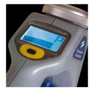
Im P-Modus empfängt das SuperC.A.T "Strom"-Signale, welche von stromführenden Kabeln ausgestrahlt werden.
