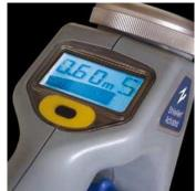
Im Sonden-/CPS-Modus werden entweder die verbreiteten Sondenfrequenzen oder Signale des kathodischen Korrosionsschutzes empfangen.
