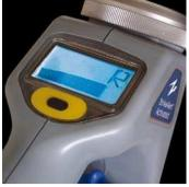
Im R-Modus empfängt das SuperC.A.T Radio-Signale, welche von erdverlegten Metallrohren und Kabeln zurückgestrahlt werden.
